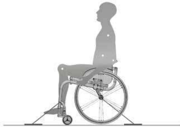
Fissaggio della carrozzina con un sistema di sicurezza a quattro punti
